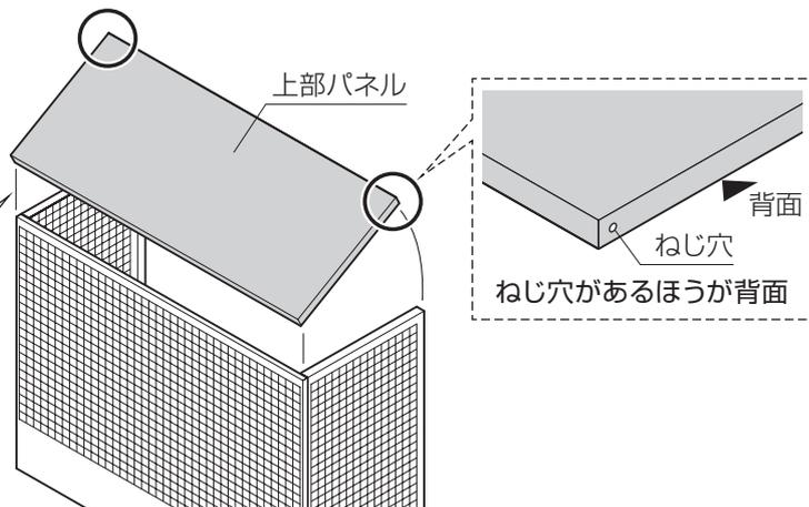
※上部パネルの取り付け直して両面テープの接着力が低下した場合は交換を行ってください。
